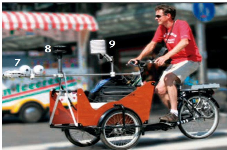
Figura 9. Ejemplo de un vehículo instrumentado para mediciones a escala local (adaptado de Urban Climate, 2017)
